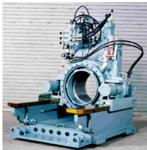
写真-1 SHミニ工法 推進装置全形
