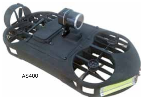
写真-1 管内調査ドローン 4)
