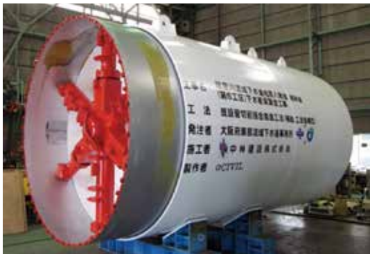
写真-2 MELIT掘進機 既設管切削時（切削リング伸長）
