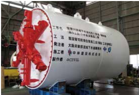
写真-1 MELIT掘進機 通常掘進時（切削リング格納）
