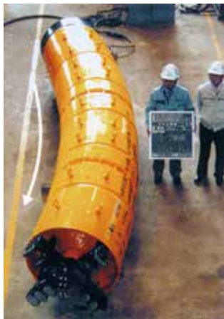
写真-2 超急曲線施工掘進機のイメージ (本現場で採用したものではありません)
