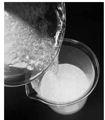
写真-1 高吸水性のポリマ系滑材の性状
