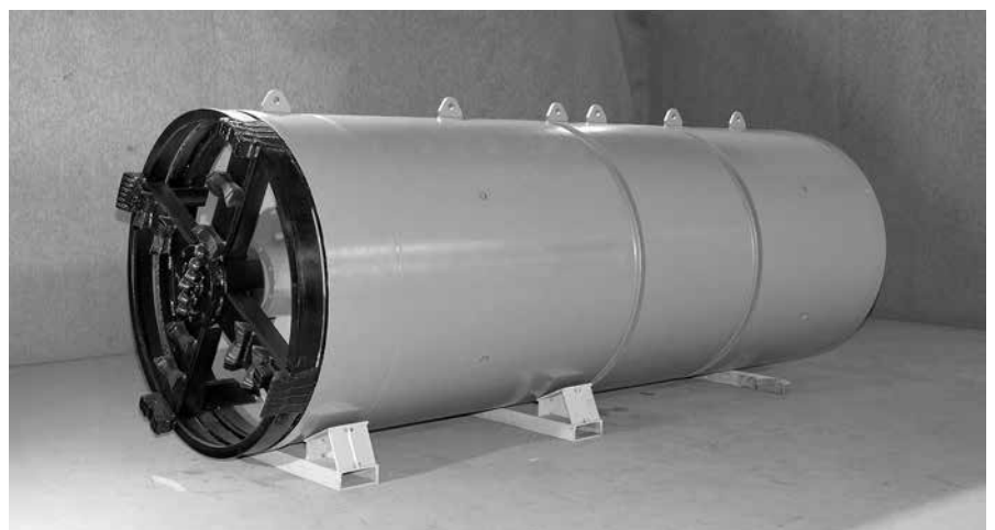
写真-1 外殻残置型掘進機（ツーウェイ掘進機）
