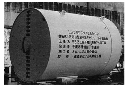
写真-1 呼び径3000機械式土圧対抗型泥水セミシールド掘進機
