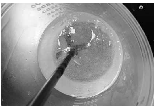
写真-2 スムースエースの練上がり状態
