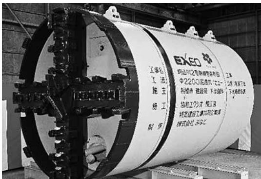
写真-2 管きょ利用が可能な掘進機 (ヒューム管推進工法)
