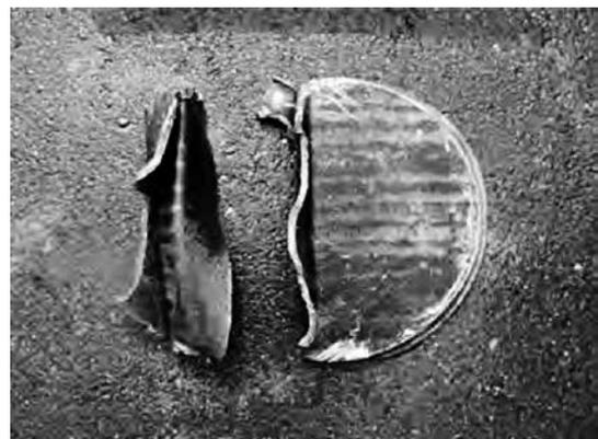
写真-4 障害物切断回収（鋼矢板）
