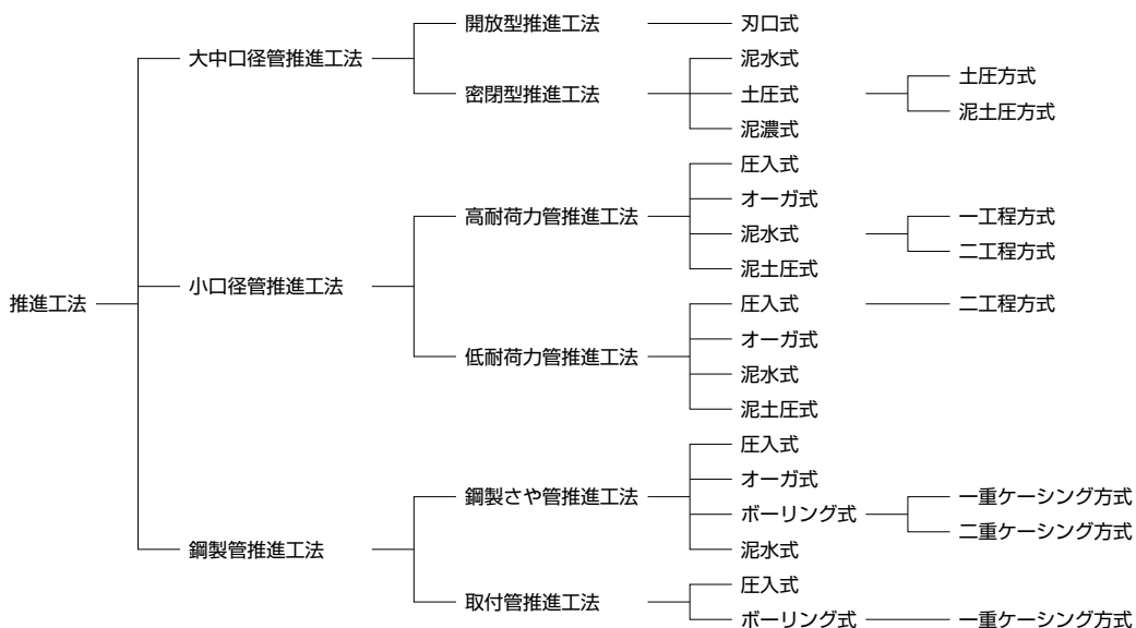
図-1 推進工法の分類
