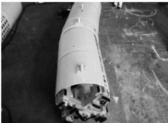
写真-2 急曲線対応型掘進機
