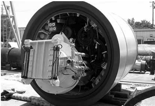
写真-3 土圧式掘進機 スクリュコンベヤ（軸スクリュ+正面ゲート）
