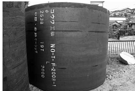
写真-1 φ2,500mm鋼製ケーシングの外観
