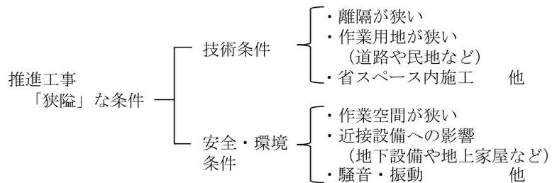
図-1 推進工事での「狭隘」な条件
