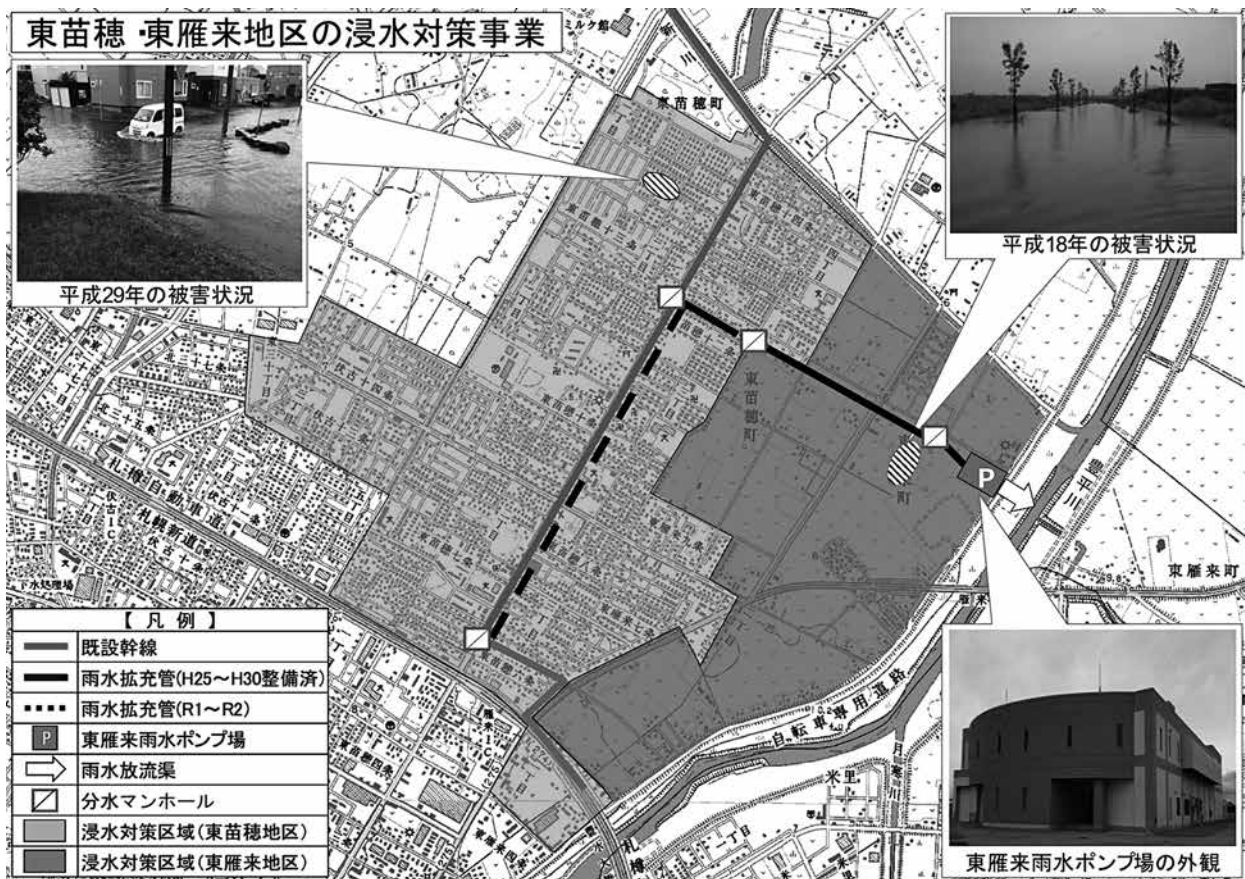
図-2 東苗穂・東雁来地区の浸水対策事業概要（令和2年（2020）2月時点）
