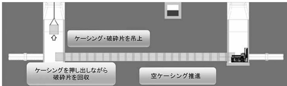
図-2 KRM改築推進概要図（既設管回収時）
