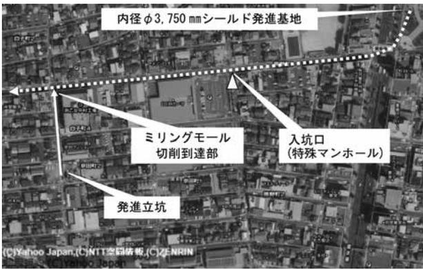
図-2 ミリングモール工法 施工平面図
