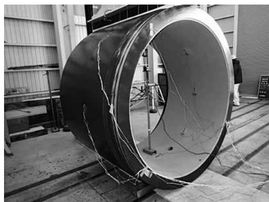
写真-5 ひずみゲージ取り付け状況
