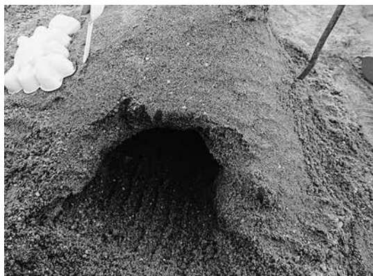
写真-1 砂山トンネル（土留めの基本）
